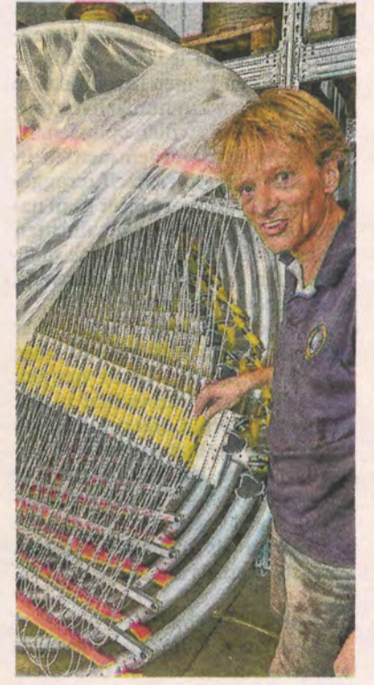
Van Haren toont de ultragevoelige temperatuursensoren die het drie jaar moeten uithouden op tweeënhalve kilometer diepte. FOTO RENÉ POP
