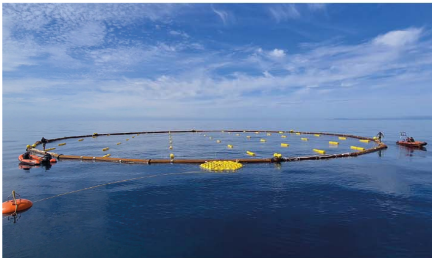
Onderzoekers van de KM 3 NeT-collaboratie en het NIOZ zetten lijnen met duizenden temperatuursensoren uit in de buurt van het Franse deel van de neutrino telescoop KM 3 NeT (foto: NIOZ).
