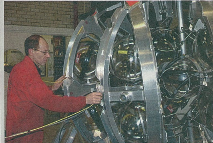
De verankering van het NIOZ bestaat uit een open aluminium bol met een diameter van twee meter, gevuld met 37 kleine glazen bollen, die bestand zijn tegen een waterdruk van 600 bar, en twee lijnen van 700 meter lang.
